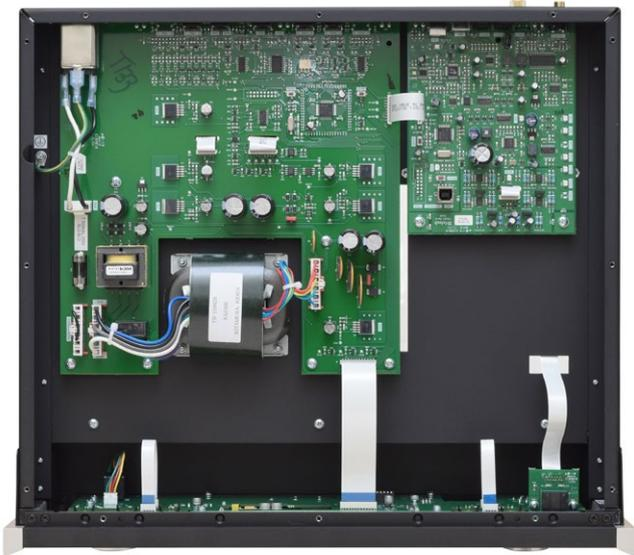
機身底部就是供電及數碼部分，靠近中央位置是一隻 Kitamura Kiden 北村機電生產的 R-Core 變壓器，穩壓和各個 trigger 介面棲身在同一塊 PCB，上面可以找到 Atmel Corporation ATSAM4S8B 32bit 處理器。
