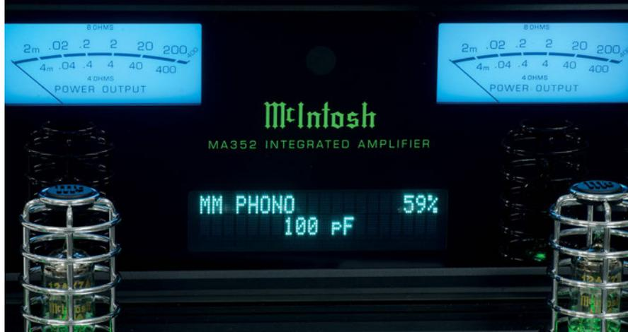
*Tra le regolazioni disponibili sull'ingresso fono c'è la possibilità di variare la capacità d'ingresso, a step di 50 pF. Non si deve invece immaginare di poter alzare la sensibilità mediante la regolazione fine del livello, che è un controllo che agisce in termini differenziali rispetto agli altri ingressi e non sul guadagno assoluto del circuito.*
