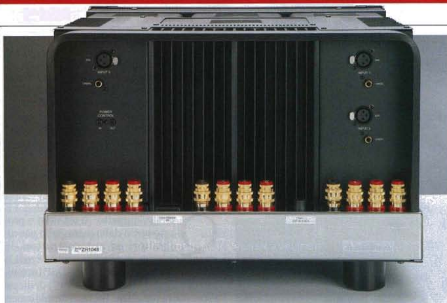
Un particolare che spesso viene sottovalutato: i morsetti per i diffusori. Quelli utilizzati nel 303 sono massicci, comodi da impugnare, anche se con dita non proprio sottili (come quelle del sottoscritto) esercitare il giusto sforzo è un po' complicato per via della vicinanza. Ma una volta correttamente serrati, non si muovono più.
