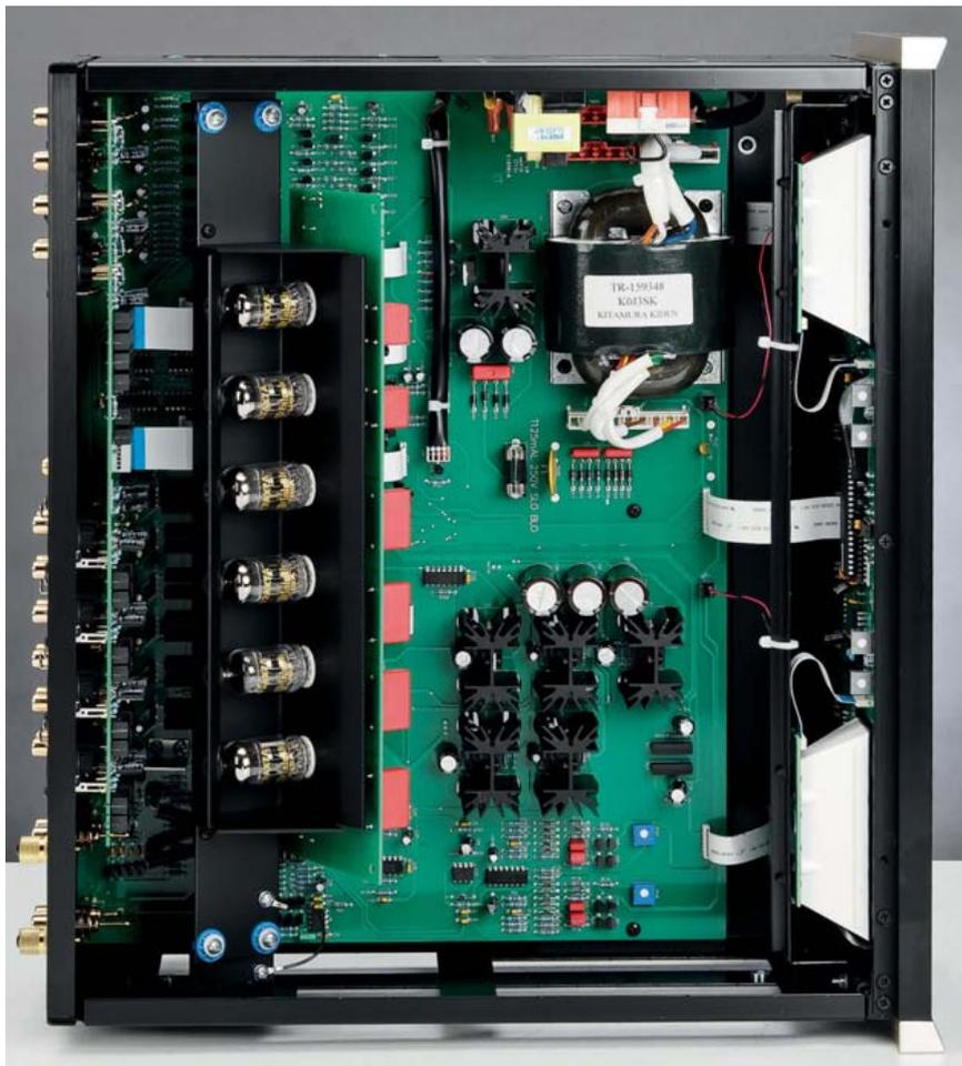
*I sei doppi triodi sono posti su una basetta autonoma montata obliquamente e connessa alla mother board mediante piattine multifilari. Numerosissime le commutazioni elettromeccaniche: abbiamo contato 53 relè blindati, dall'azione estremamente silenziosa.*
